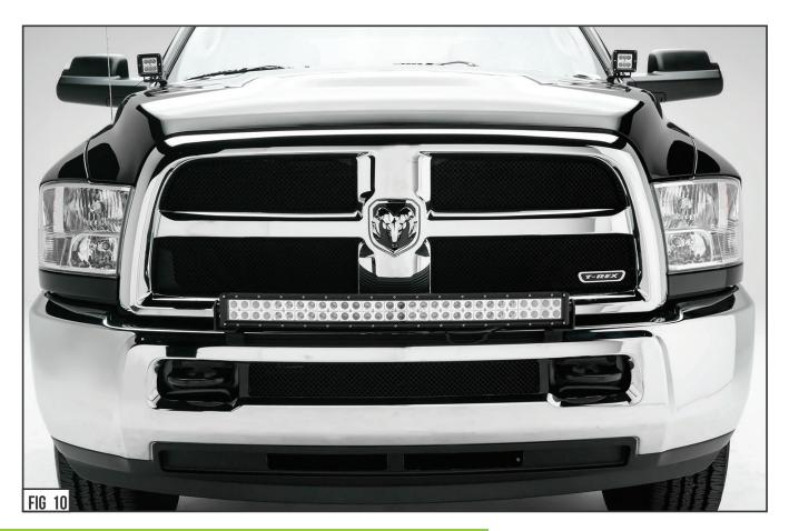
LED LIGHT BRACKET INSTALLATION - PROCESS COMPLETE
