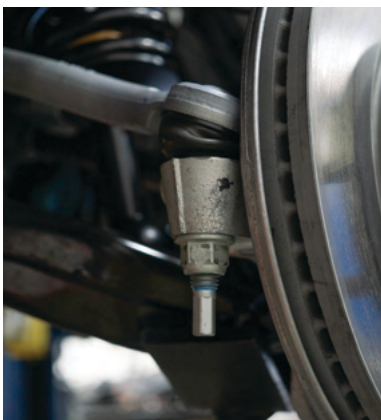
Fig. 21: Tie rod end link.
