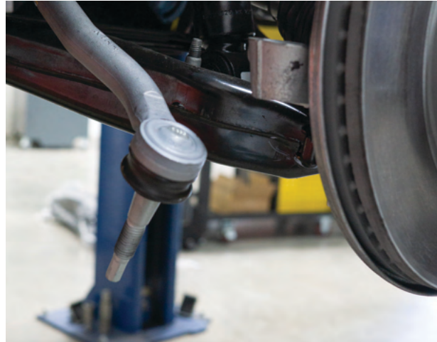
Fig. 4: Tie rod end link.
