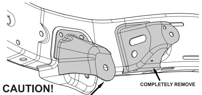
ONLY REMOVE THE INSIDE PORTION OF THE STOCK LOWER CONTROL ARM BRACKET
