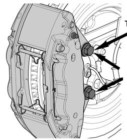
**USE BLUE** THREAD LOCK ON THE **FACTORY CALIPER BOLTS**
